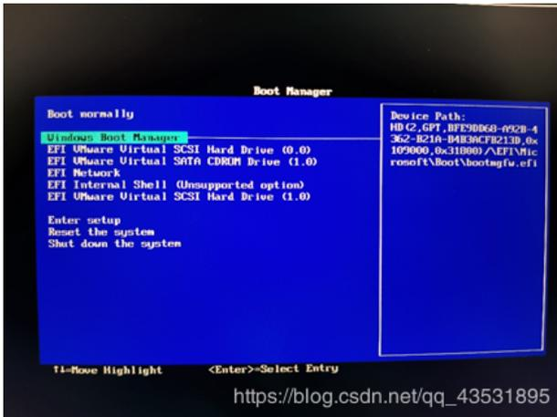
图中的最下面的EFI VMware Virtual SCSI Hard Drive即为新加U盘（正常物理机应该是USB设备，我这里同样使用VMware虚拟机进行实验）
